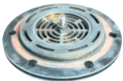
2,500 小时后的 风冷式第 3 级压缩气阀
